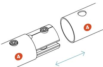
Verrouillage des sections par clé Allen
