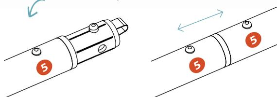
Assemblage des sections 50 mm
