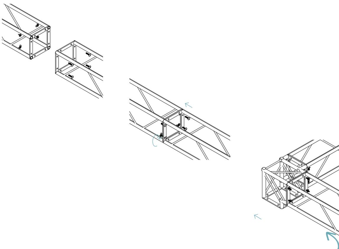
Les différentes sections s'assemblent facilement
