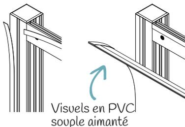
L'habillage par panneaux rigides (5mm) vous permet d'encastrer directement le panneau dans la rainure du mât. Dans le cas où vous souhaitez habiller entièrement la structure, des velcros mâle et femelle seront utilisés au dos et sur la structure.
